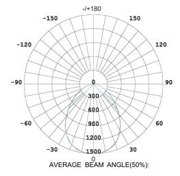
UNIT: CD C0/180 , 89. 2deg C30/210 ,88. 9deg C60/240 ,89. 3deg C90/270 ,89. 9deg
